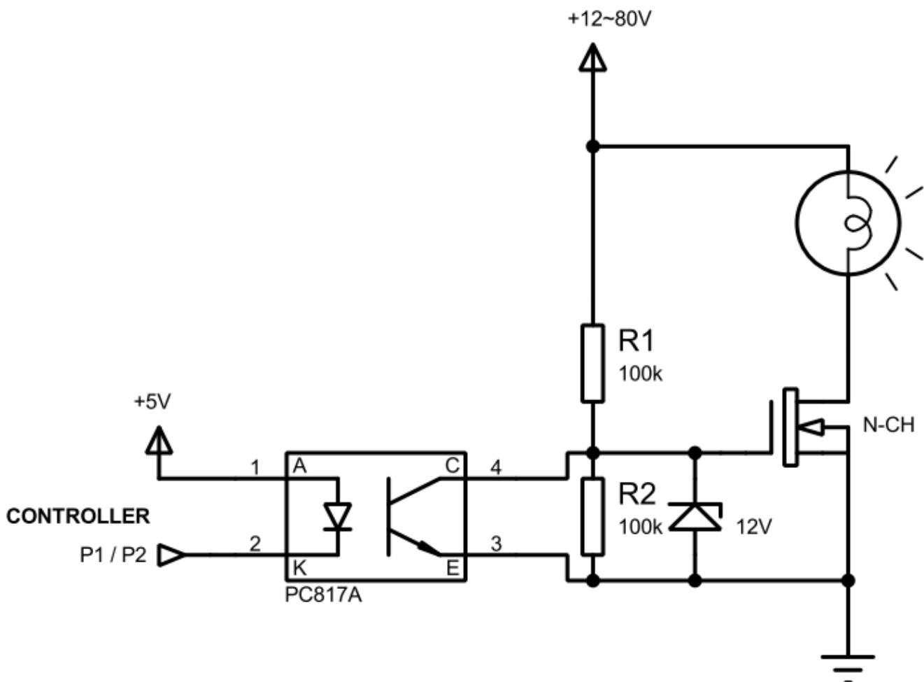
Для управления вентилятором требуется 4-х проводной вентилятор. 20кГц по умолчанию но можно попробовать и меньше. Схема:
