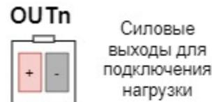
3А на канал, общее не более 10А, каналы можно параллельно вертикально, например OUT3+OUT4
